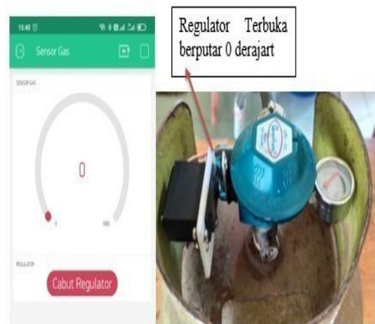
Gambar 14. Pengujian Aplikasi Mobile dan Motor Servo, tombol di tekan cabut regulator
