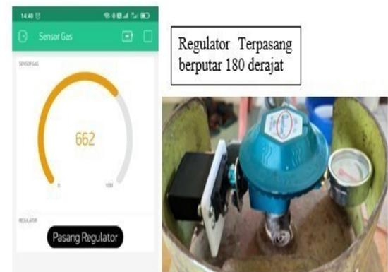
Gambar 15. Pengujian Aplikasi Mobile dan Motor Servo, tombol ditekan pasang regulator
